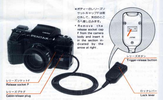
ケーブルスイッチFは、レリーズソケットFを持つペンタックスカメラ用のアクセサリーです。 三脚やコピースタンドを用いて、低速シャッターで撮影するときなどにご使用ください。 写真のように、カメラのレリーズソケットへ、 PENTAXが見える方向〔ズーム105系やズーム90の場合は、PENTAXの面が上になるよう〕にレリーズプラグを差し込んで、使用します。なお、カメラの説明書も合わせてご覧ください。 Z-10・SFシリーズのカメラにK\*・Kマウントレンズを組み合わせて、被写体像がフォーカスフレームの中に飛び込んだときシャッターが切れるスナップインフォーカス撮影もできます。
